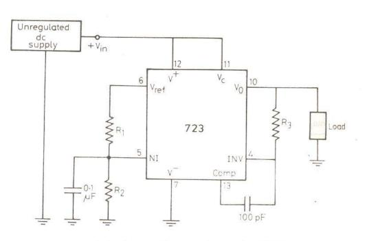
A low voltage regulator using 723 IC
